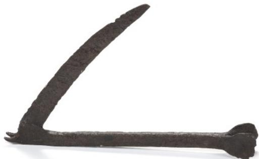
Geschmiedeter Winkel. Ein Winkelarm aus einem Vierkanteisen, ein Ende zu einer halbkreisförmigen Tülle ausgeschmiedet, das andere Ende spaltet sich zu einem Geißfuß. Hier der zweite, bogenförmige Arm in einem Winkel von ca. 55° angesetzt, mit außenseitiger Schneide und sich zu einer Spitze verjüngend.
